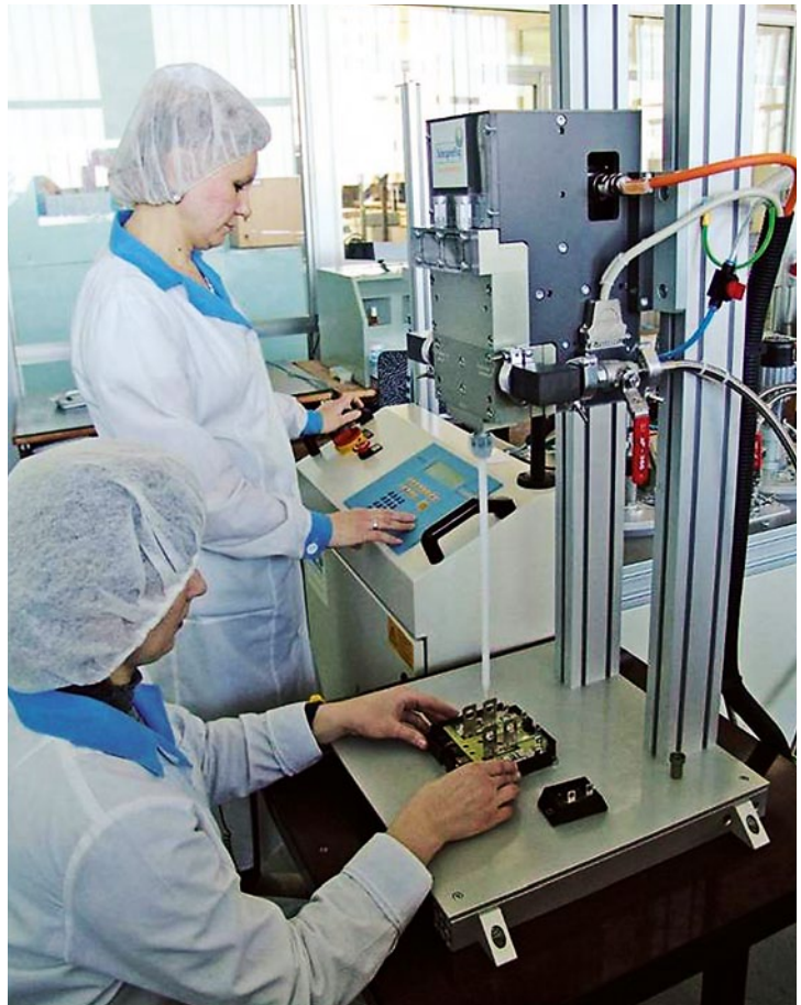
Дозированная заливка IGBT-модулей защитными компаундами
